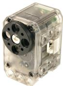
**Servomoteur Dynamixel XL-320** La communication se fait par le biais d'une liaison 3 broches en TTL (Vcc, Gnd, data) encore appelée **liaison série asynchrone**, avec un débit maximum de 1Mbps. Les servomoteurs dynamixels sont reliés en série entre eux et avec une alimentation comprise entre 6 et 8V. [Documentation XL-320](#)
